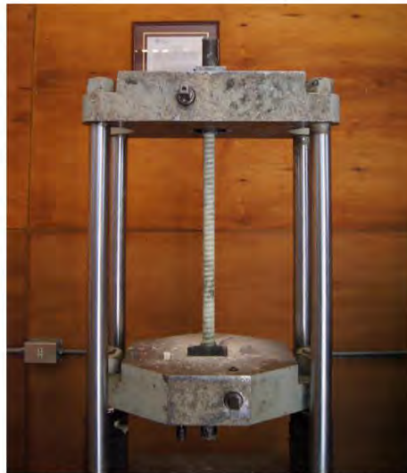
Figura B.1 Ensayo de tracción realizado al perno fibra de vidrio \phi 25\text{mm} .
