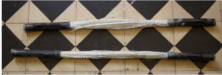
Figura B.2 Pernos luego de los ensayos realizados.
